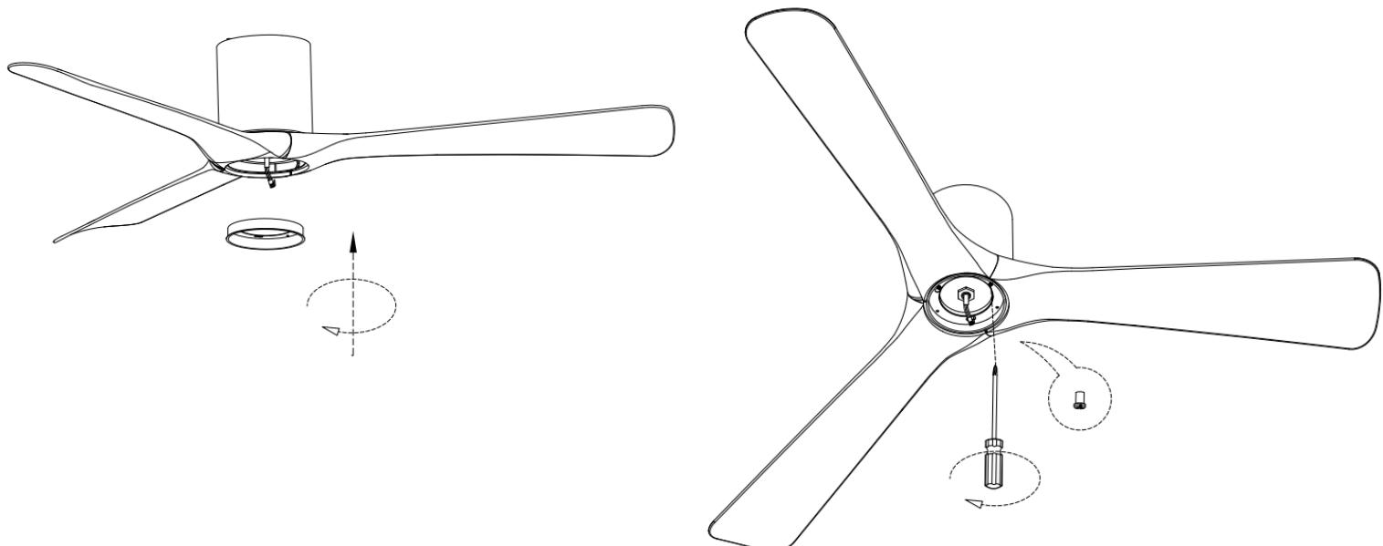
6. Αφαιρέστε τις τρεις βίδες από τη μονάδα του κινητήρα. Ευθυγραμμίστε τις τρεις οπές στη βάση του κιτ φωτισμού. Βεβαιωθείτε για την εγκοπή στη βάση του κιτ φωτισμού. Τοποθετήστε τη βάση του κιτ φωτισμού και τοποθετήστε ξανά τις τρεις βίδες που αφαιρέθηκαν στο πρώτο βήμα για να στερεώσετε τη θήκη του κιτ φωτισμού.
