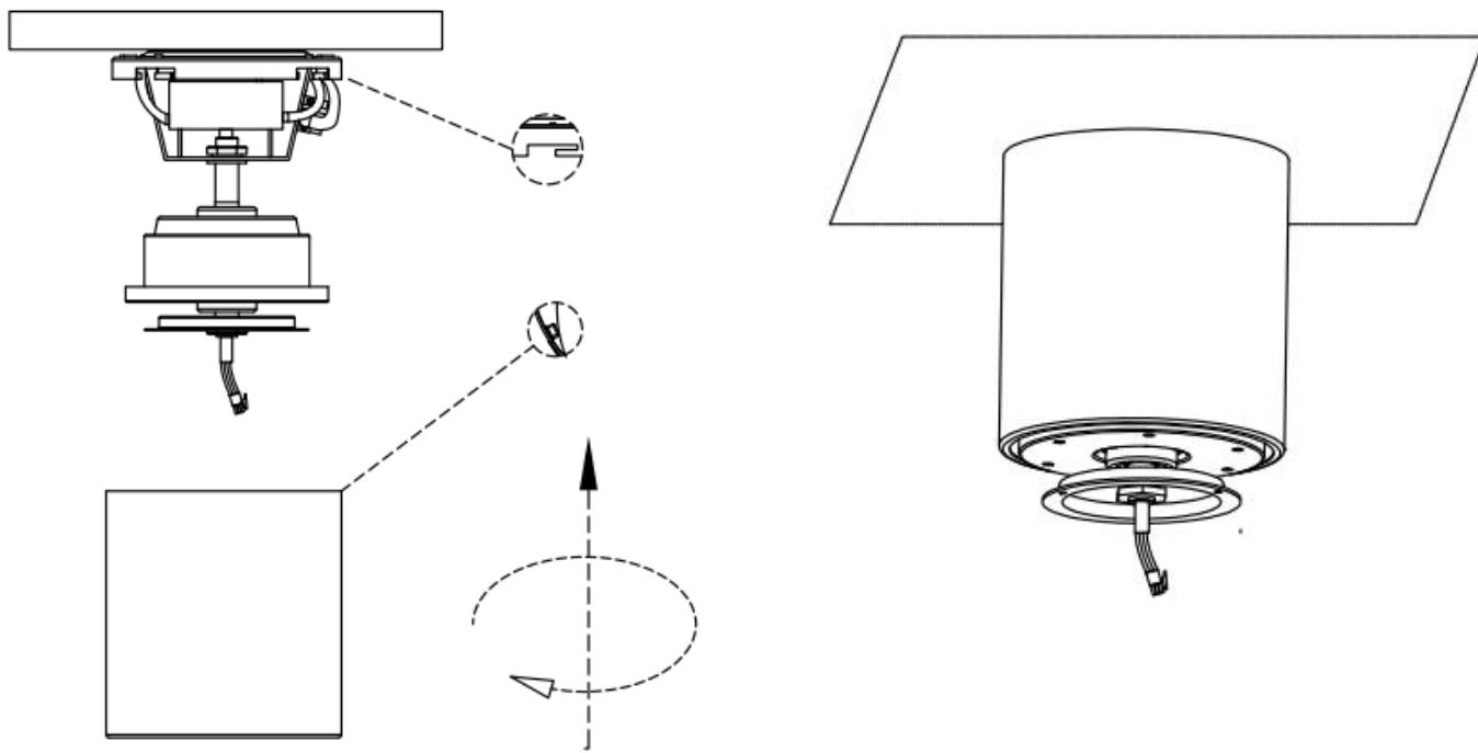
4. Τοποθετήστε προσεκτικά το Το περίβλημα του κινητήρα στη μονάδα του κινητήρα και ευθυγραμμίστε τις υποδοχές ασφάλισης του περιβλήματος, με τις τέσσερις υποδοχές ασφάλισης στο δίσκο στήριξης. Σπρώξτε προς τα πάνω μέσα στην υποδοχή κλειδώματος και περιστρέψτε δεξιόστροφα για να ασφαλίσει στη θέση του.
