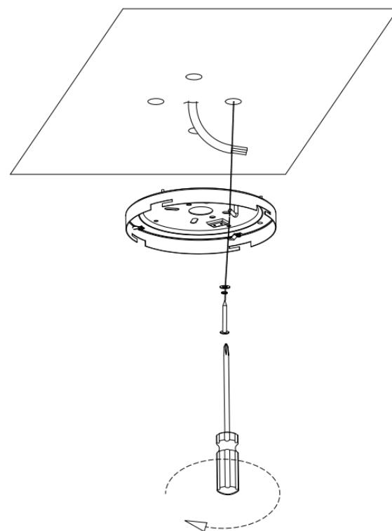
1. Εγκαταστήστε το συρόμενο δίσκο του βραχίονα στήριξης στην οροφή. (παρακαλούμε βεβαιωθείτε ότι η στερέωση μπορεί να υποστηρίξει το ελάχιστο βάρος κίνησης του ανεμιστήρα που είναι 15,8 kg=35Lb)
