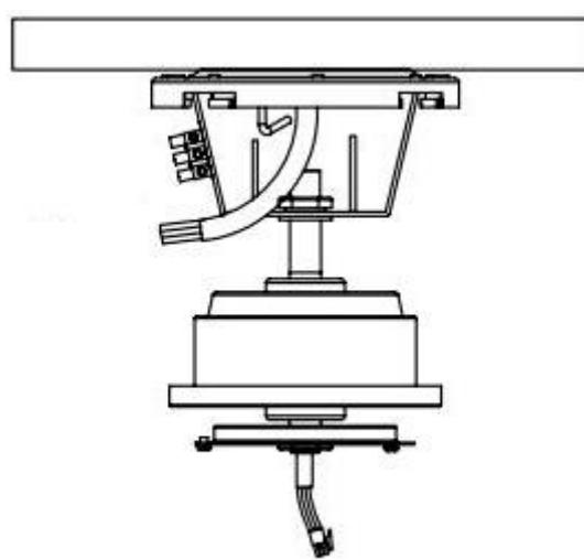
2. Σηκώστε προσεκτικά τη μονάδα του κινητήρα μέχρι το συρόμενο δίσκο του βραχίονα στήριξης . Τοποθετήστε τον κινητήρα χρησιμοποιώντας τις 4 βίδες στερέωσης στο συρόμενο δίσκο του βραχίονα στήριξης .
