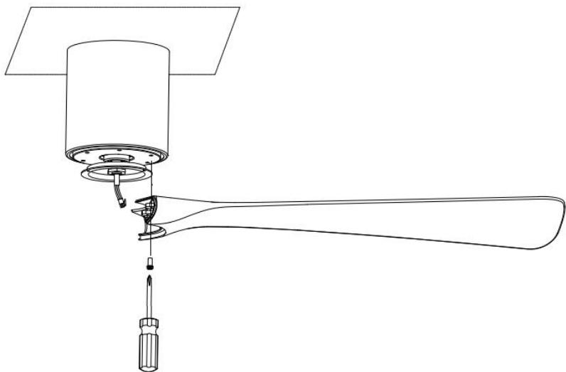
5. Στερεώστε το πτερύγιο στη μονάδα του κινητήρα, με τις βίδες του βραχίονα του πτερύγιου.
