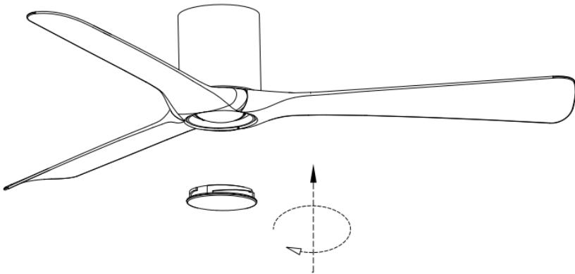
8. Τοποθετήστε το γυάλινο κάλυμμα στη βάση του κιτ φωτός. Γυρίστε το γυάλινο μπολ δεξιόστροφα μέχρι να σταματήσει.
