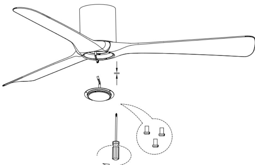
7. Συνδέστε το βύσμα 2 ακίδων που εξέρχεται από το κάτω μέρος του κινητήρα του ανεμιστήρα στο βύσμα 2 ακίδων από τη θήκη του κιτ φωτός LED. Στερεώστε το κιτ φωτός LED στο κιτ φωτισμού.
