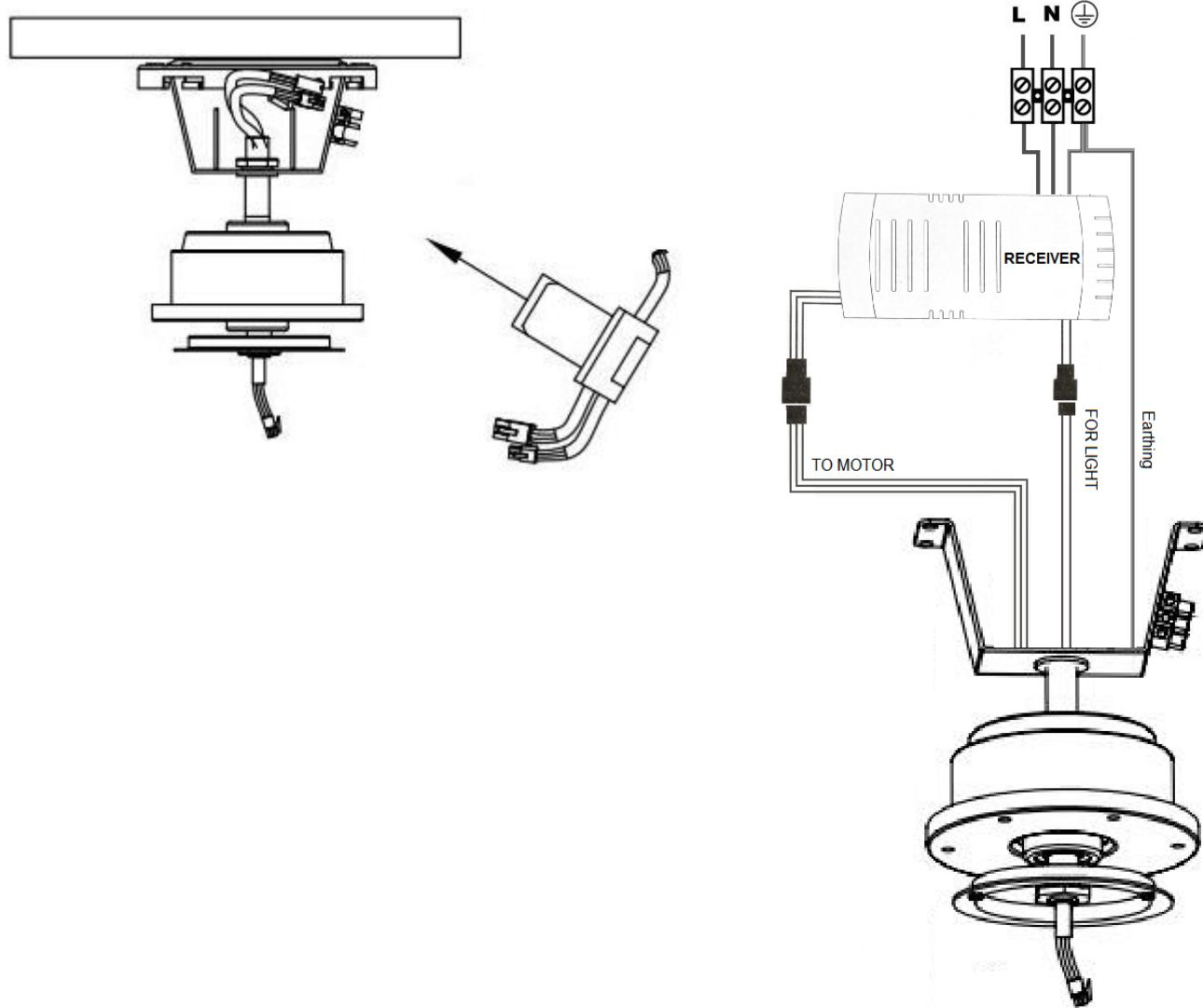
3. Ρυθμίστε τον απομακρυσμένο δέκτη στο πλαίσιο U του κινητήρα. Καλωδίωση σύμφωνα με το διάγραμμα καλωδίωσης του τηλεχειριστηρίου.
