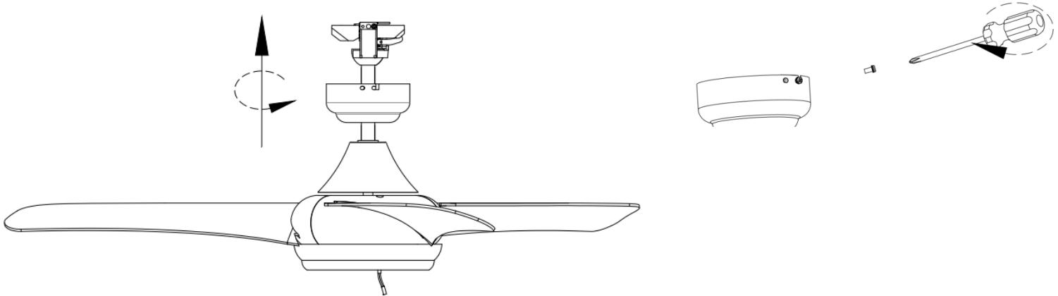
7 Συναρμολογήστε ξανά το κουβούκλιο με το στήριγμα και χρησιμοποιώντας τις βίδες στερέωσης για να σφίξετε το κουβούκλιο, βεβαιωθείτε ότι ο θόλος είναι ασφαλισμένος και ότι δεν έχουν εγκλωβιστεί καλώδια.
