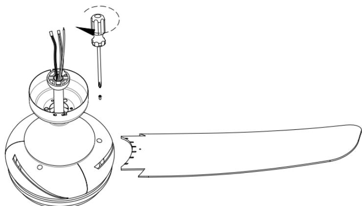
4. Εισαγάγετε το πτερύγιο ABS στη μονάδα του κινητήρα. Κλειδώστε τη βίδα του πτερύγιου.
