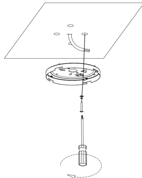
2. Τοποθετήστε το στήριγμα στήριξης στην οροφή, (παρακαλούμε βεβαιωθείτε ότι η στερέωση μπορεί να υποστηρίξει το ελάχιστο βάρος κίνησης του ανεμιστήρα που είναι 15,8 kg=35Lb)
