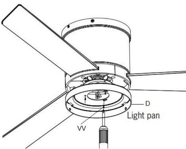
7. Αφαιρέστε τις τρεις βίδες (VV) από τη μονάδα του μοτέρ. Ευθυγραμμίστε τις τρεις οπές στη βάση του κιτ φωτισμού (D). Βεβαιωθείτε ότι η εγκοπή στο δοχείο φωτιστικού (D) Τοποθετήστε το δοχείο του κιτ φωτισμού (D) και επαναλάβετε -τοποθετήστε τις τρεις βίδες (VV) που αφαιρέθηκαν στο πρώτο βήμα για να στερεώσετε τη βάση του κιτ φωτισμού (D).
