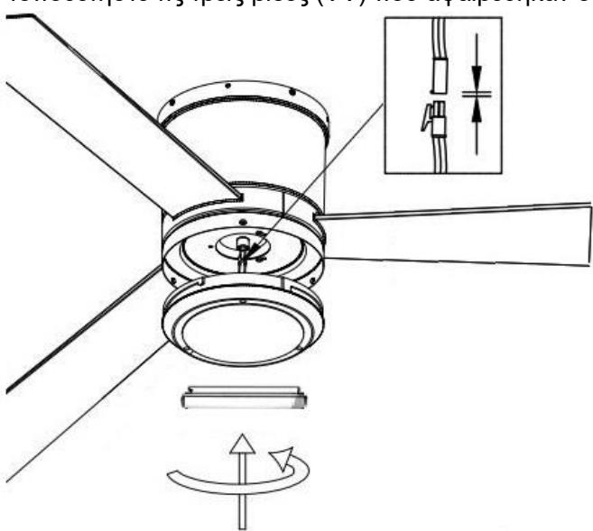
8. Συνδέστε το βύσμα 2 ακίδων που εξέρχεται από το κάτω μέρος του κινητήρα του ανεμιστήρα στο βύσμα 2 ακίδων από τη θήκη του κιτ φωτός LED. Στερεώστε το κιτ φωτός LED στο κιτ φωτισμού . Τοποθετήστε το γυάλινο καπάκι στη βάση του κιτ φωτός. Γυρίστε το γυάλινο καπάκι δεξιόστροφα μέχρι να σταματήσει.
