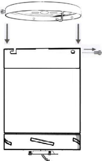
1. Αφαιρέστε το στήριγμα στερέωσης από τη μονάδα του κινητήρα ανεμιστήρα χαλαρώνοντας τις δύο βίδες θόλου που βρίσκονται στις στρογγυλές οπές. Αφαιρέστε και αποθηκεύστε τις δύο βίδες στερέωσης στις υποδοχές σχήματος "L". Αυτό θα σας επιτρέψει να αφαιρέσετε το στήριγμα στερέωσης.
