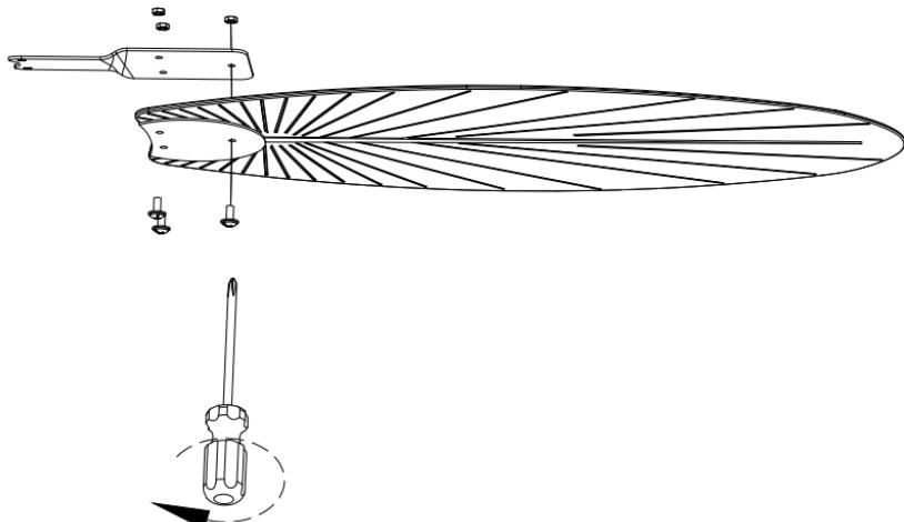
8. Προσαρμόστε το πτερύγιο στο στήριγμά του και σφίξτε το χρησιμοποιώντας τη βίδα στερέωσης του πτερύγιου, τη ροδέλα και το παξιμάδι.
