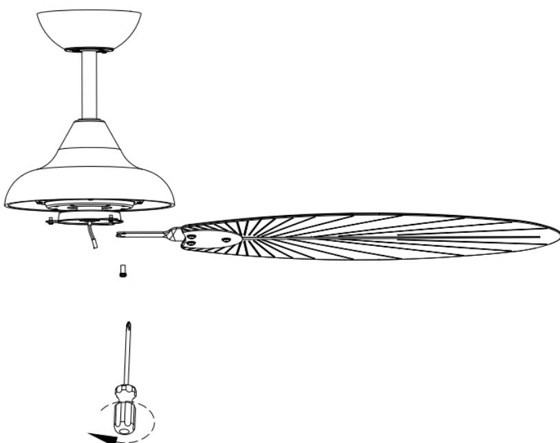
9 . Αφαιρέστε τις βίδες του βραχίονα του πτερύγιου από τη μονάδα του μοτέρ. Στερεώστε το στήριγμα του πτερύγιου στη μονάδα του μοτέρ, με τις βίδες του βραχίονα του πτερύγιου.
