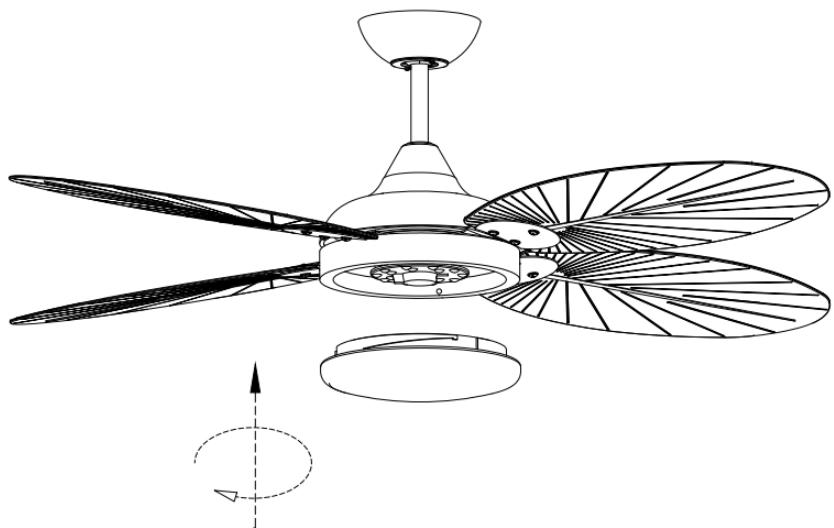
12. Τοποθετήστε το γυάλινο κάλυμμα στη βάση του φωτιστικού. Γυρίστε το δεξιόστροφα μέχρι να σταματήσει.
