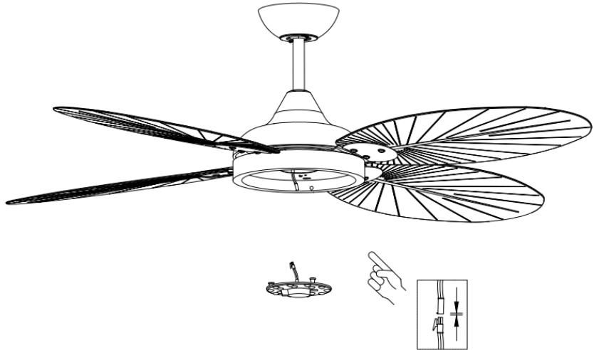
11. Συνδέστε το βύσμα 2 ακίδων που εξέρχεται από το κάτω μέρος του κινητήρα του ανεμιστήρα στο βύσμα 2 ακίδων από τη θήκη του κιτ φωτός LED. Στερεώστε το κιτ φωτός LED στο κιτ φωτιστικού.
