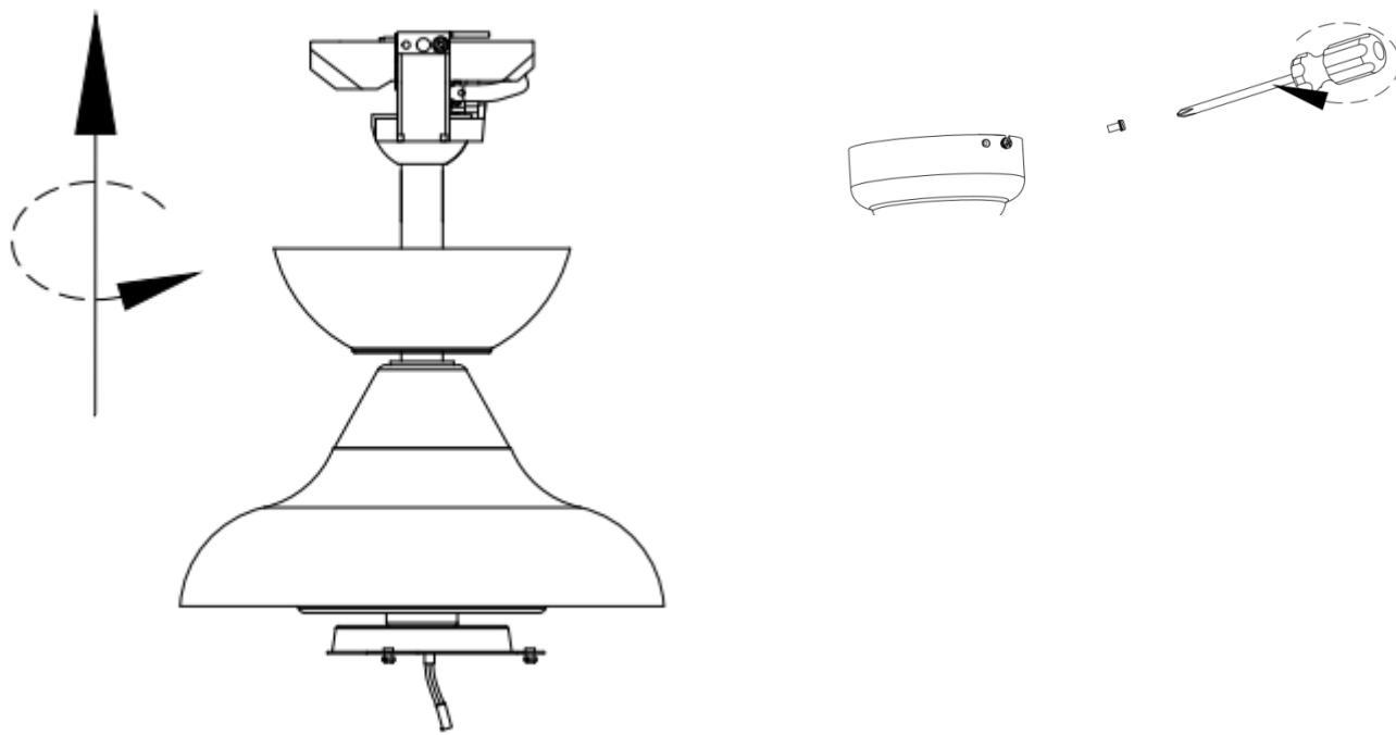
7. Συναρμολογήστε ξανά το κουβούκλιο με το στήριγμα και χρησιμοποιώντας τις βίδες στερέωσης για να σφίξετε το κουβούκλιο, βεβαιωθείτε ότι ο θόλος είναι ασφαλισμένος και ότι δεν έχουν εγκλωβιστεί καλώδια.
