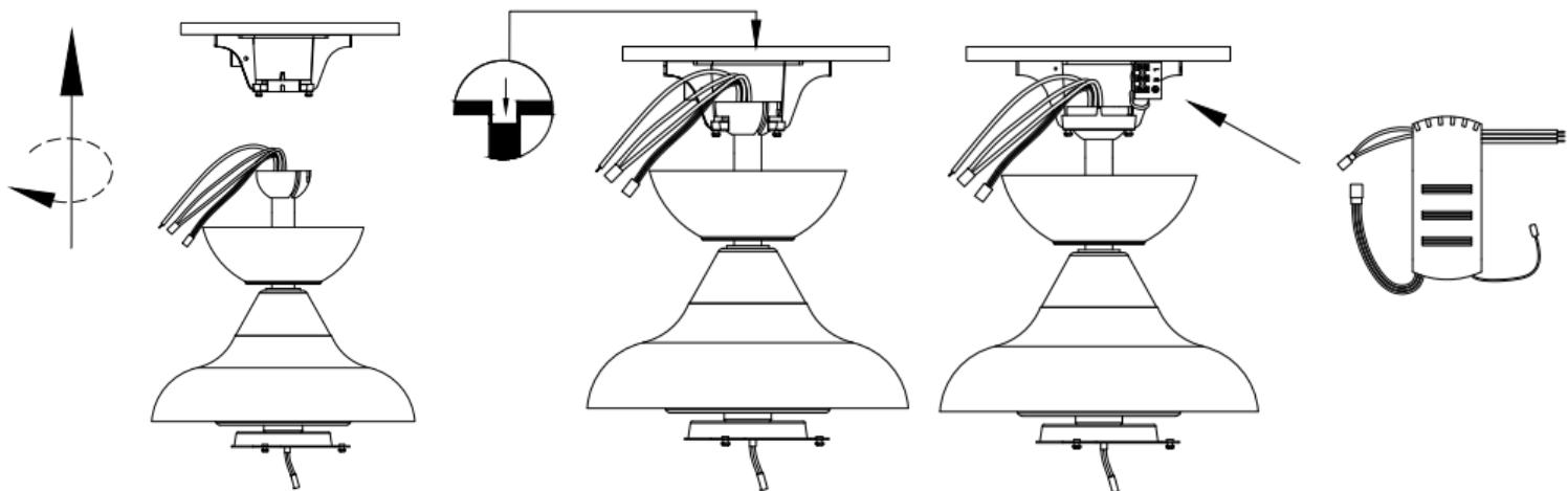
5 . Σηκώστε τον ανεμιστήρα και τοποθετήστε τη νάιλον μπίλια στο στήριγμα. Βεβαιωθείτε ότι ο οδηγός πείρος του βραχίονα εφαρμόζει στην υποδοχή της μπίλιας. Τοποθετήστε τον δέκτη τηλεχειριστηρίου, στη μέση του βραχίονα και συνδέστε τα καλώδια. (συνδέστε τα καλώδια σύμφωνα με τις οδηγίες καλωδίωσης).
